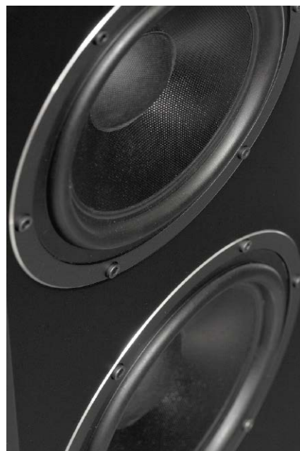
Głośniki niskotonowe wyglądają (z zewnątrz) tak jak w ZGZ-802, ale zostały zmodyfikowane w celu lepszego rozciągnięcia charakterystyki (niższa częstotliwość rezonansowa).
